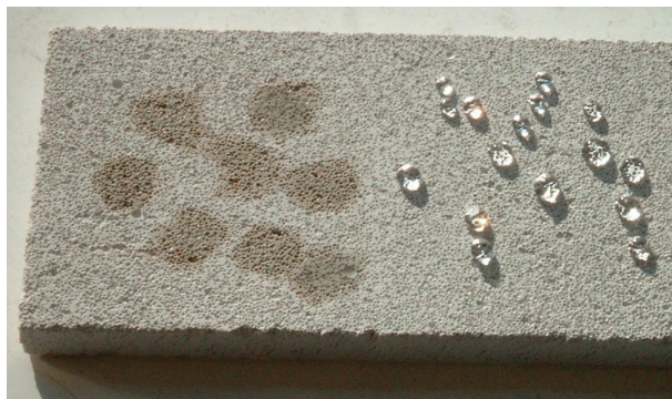
Die rechte, behandelte Steinhälfte zeigt deutlich die wasserabstoßende Wirkung von Porophob-F. Die linke, unbehandelte Steinhälfte hat die Wassertropfen sofort aufgesaugt.
